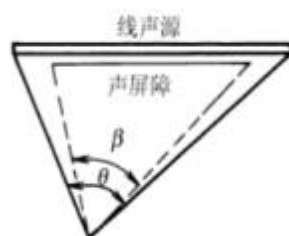
图 1-3 受声点与线声源两端连接线的夹角（遮蔽角）
